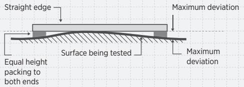
**FIGURE 1.3B VERTICAL SURFACE TOLERANCES**
